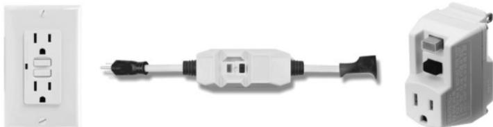
**Interruptores Con Detención De Falla A Tierra.** El *GFCI* es un dispositivo que actúa rápido, detecta un pequeño escape de electricidad a la tierra. Dentro de 1/40 de un segundo apaga la electricidad e “interrumpe” el flujo de corriente. Proporciona una protección eficaz contra descargas eléctricas y electrocuciones. *GFCI* son requeridos para su uso en todos los sitios de construcción y proyectos. Algunas variaciones del *GFCI* se muestran más arriba.
